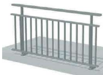
Barreaudage sous lisse intermédiaire
